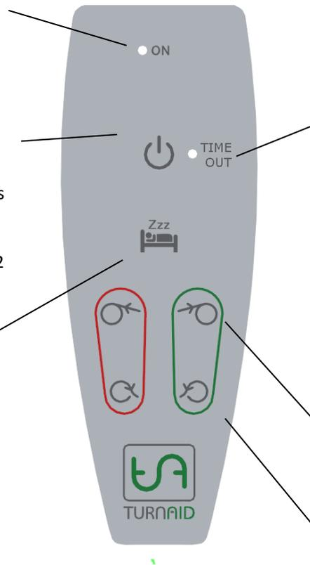
TIME OUT lysdioden blinker når systemet har været i brug i 80 sekunder, og systemet vil afgive et bip, men der kan stadig køres med rullerne. Når den gule TimeOut diode lyder skal plejeren omgående benytte TurnAid.
